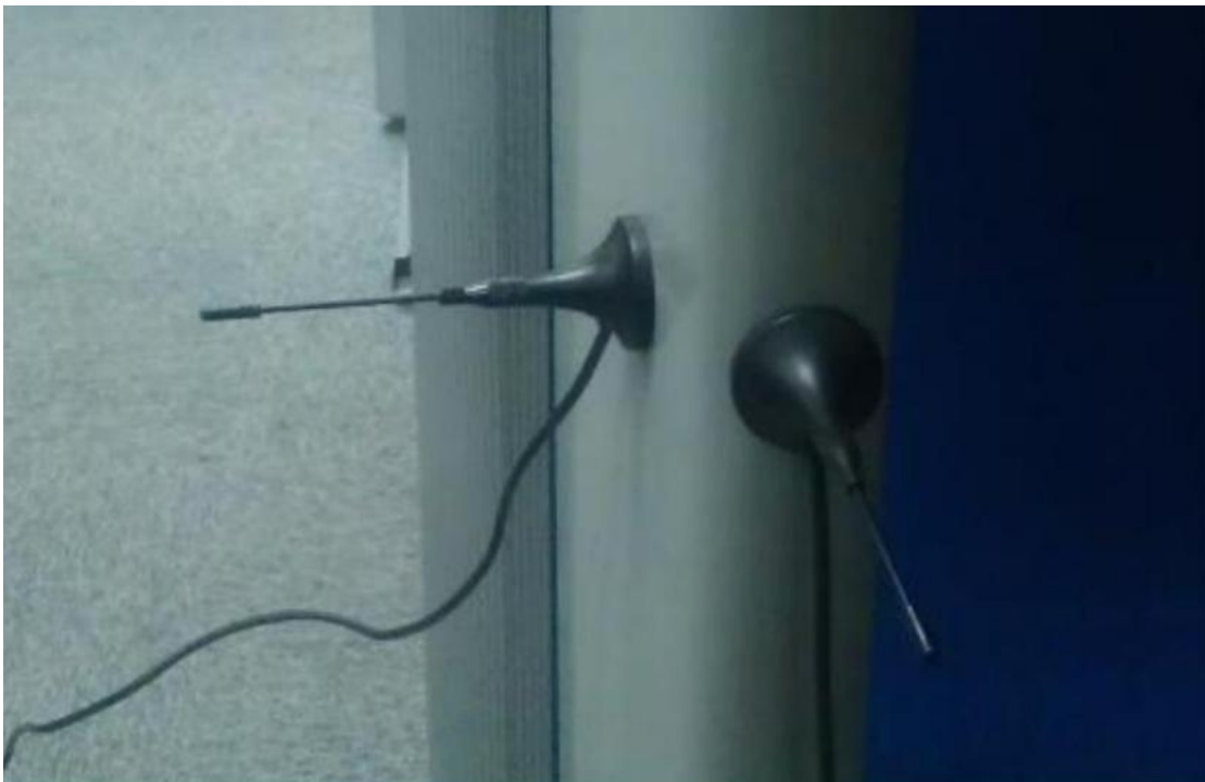
Figura 6.3 Isolamento por polarização ortogonal antena
